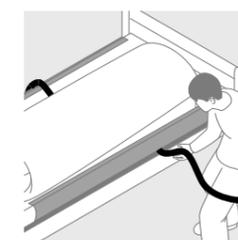
Rettungssituation: Ziehen Sie die zwei Gurtstecker mit dem Gurtband aus der Positionierung unter der Matratze hervor.
